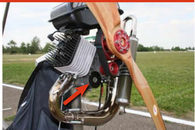
La nuova versione del C-Max da 27 hp è adesso dotata del contralbero di bilanciamento, indicato dalla freccia
